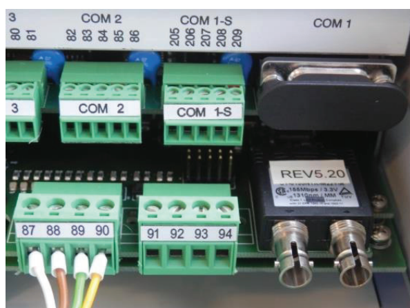
Złącza światłowodowe (1 x Ethernet-ST, XW93) na Poziomie II, porty COM REG-DA na Poziomie III
